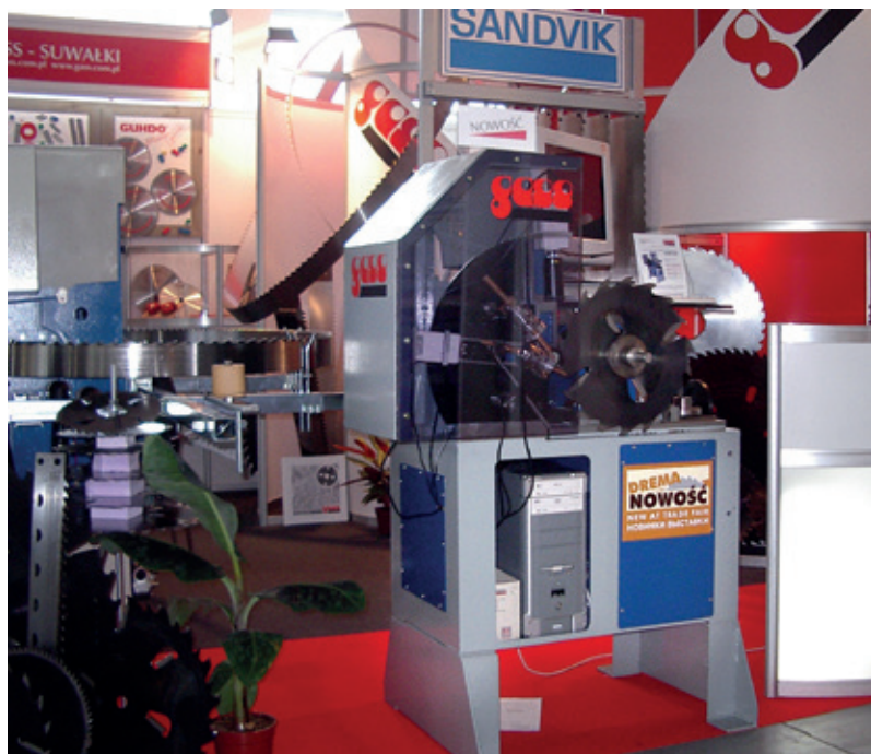
Fot. 5. Automatyczny wizyjny kontroler ostrzy pił tarczowych WKOPTar na stoisku firmy GASS sp. z o.o. na Międzynarodowym Salonie Obrabiarek i Narzędzi do Drewna DREMA 2004 (fot. autor)
