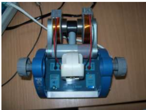
Rys.5 Jednostka główna TEL.2561 z prawidłowo podłączonymi magnesami.
