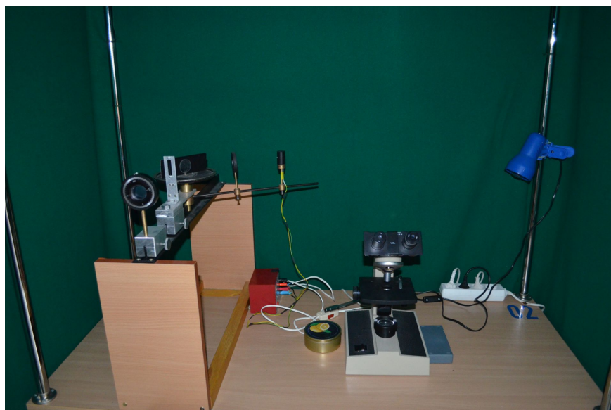
Rysunek O2.1. Zdjęcie układu pomiarowego: prawa strona - metoda Chaulnesa, lewa strona - metoda oparta na prawie Brewstera
