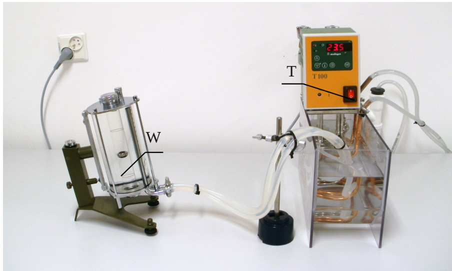
Rysunek M16.1. Zdjęcie układu pomiarowego: W – wiskozymetr Höpplera, T – termostat
